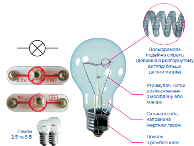
Мал. 3.1. Зовнішній вигляд, будова і умовне позначення ламп розжарювання
